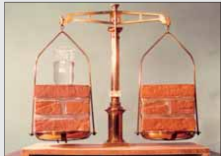
Der linke Prüfkörper wurde mit AQUOVOSS imprägniert. Er weist, gegenüber dem unbehandelten Prüfkörper rechts, nach einer Wasserbelastung deutlich weniger Wasseraufnahme (Gewicht) auf.
