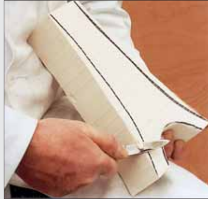
Rohlinge aus LIGHTPLAST sind mit Holzwerkzeugen bearbeitbar
